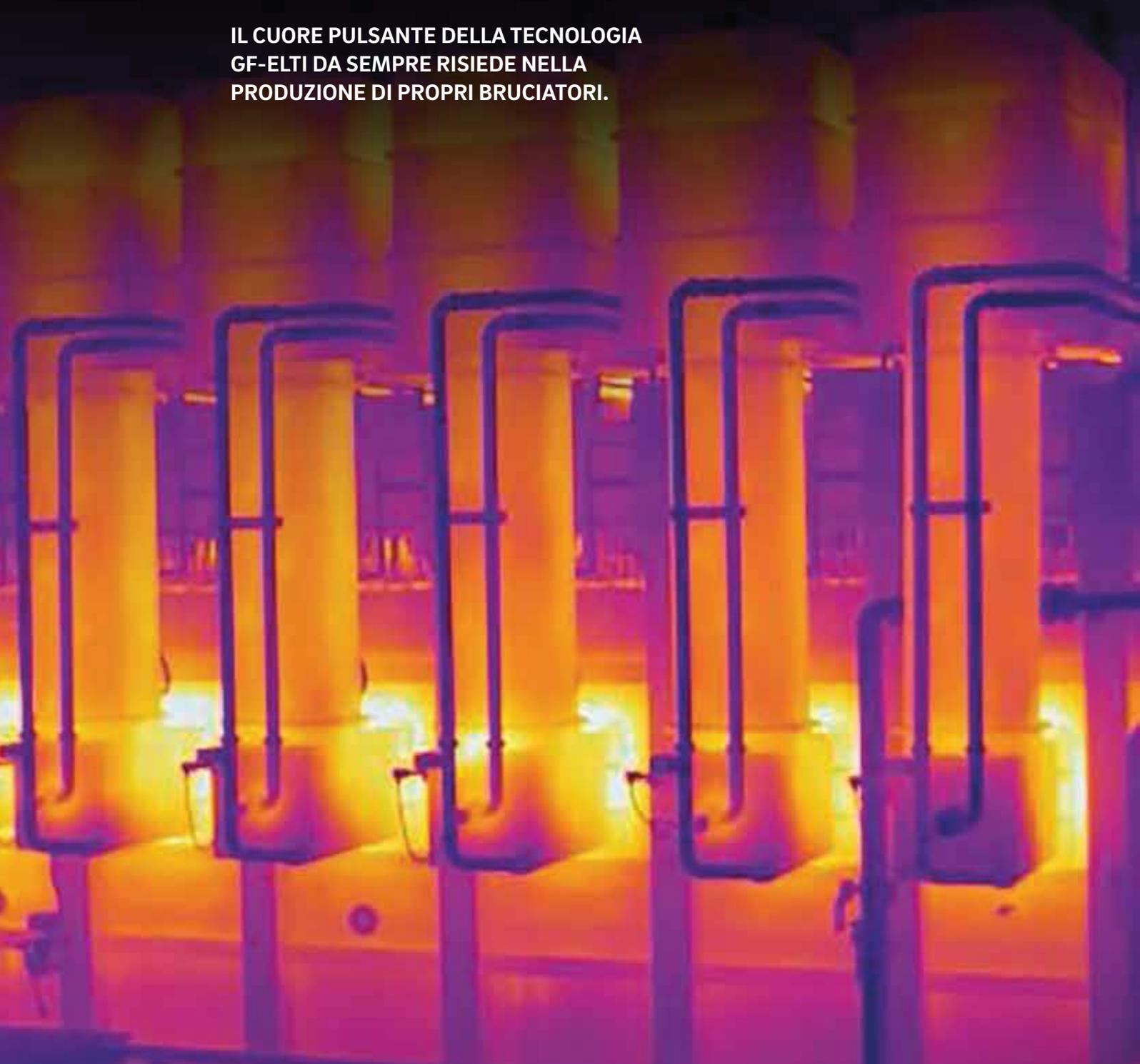
■ Forno di Riscaldamento Walking Beam - Dettaglio Bruciatori Rigenerativi
