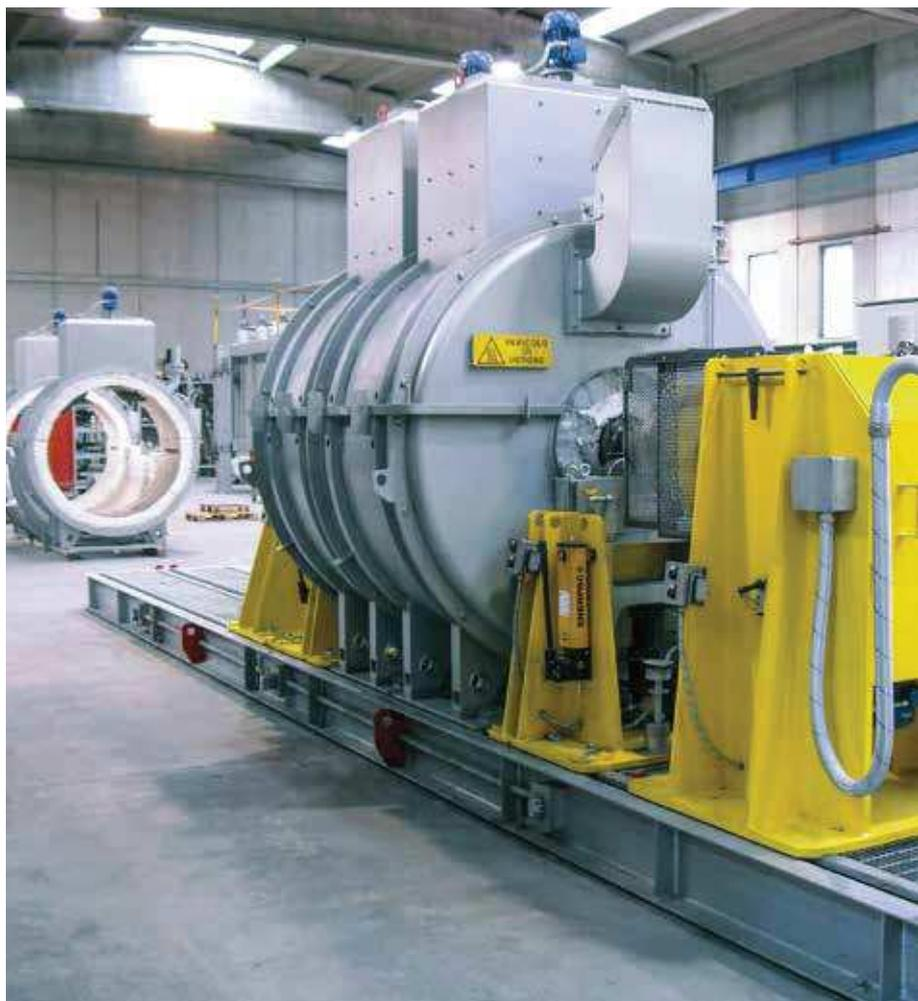
■ Impianto per Test di Stabilità Rotante a Caldo di Rotori Forgiati
