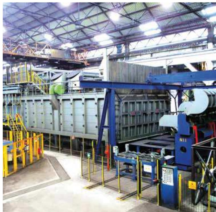
■ Linea di Trattamento Termico Walking Beam per Assili Ferroviari
