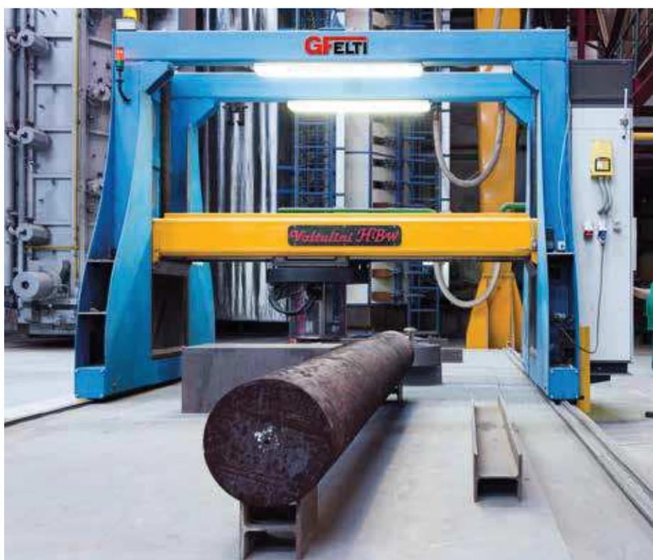
■ Impianto Automatico ad alta produttività per eseguire Test di Durezza post Trattamento Termico
